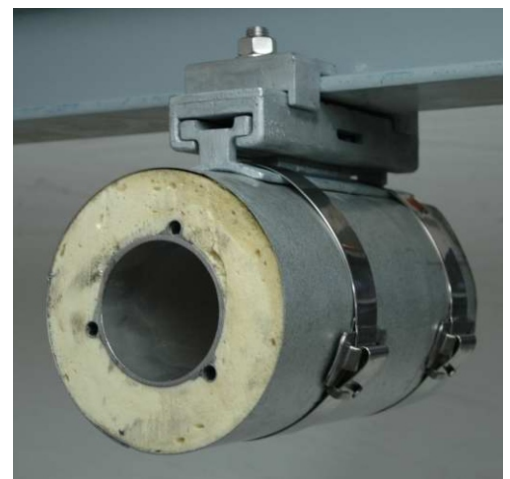
Bild 3 Gleitlager hängend Produktrohr DN80 mit PU-Isolierung AD=181 mm
